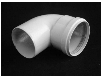
Obr. č. 13 90° koleno Ø 80 mm (Ø 100 mm), tlaková ztráta: 14 Pa
