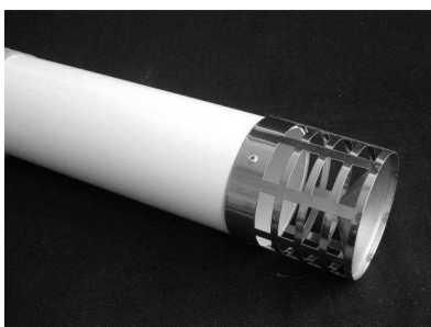
Obr. č. 15 Trubka pro odvod spalin nebo přívod vzduchu s vyústěním přes zeď Ø 80 mm (Ø 100 mm), tlaková ztráta: 10 Pa
